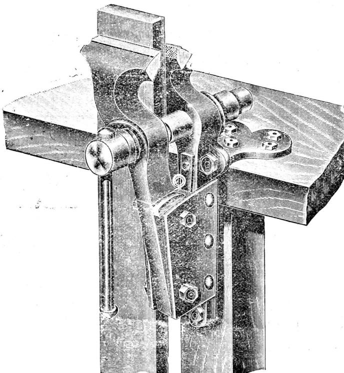
verändert ist, lassen sich beliebig lange Gegenstände an der Spindel vorbei einspannen und weil der Schraubstock in der Weise konstruiert ist, daß die Spannbacken trotz ihrer schrägen Anordnung noch innerhalb der Mitte der Druckebene der Spindel liegen, so wird der Spindeldruck genau wie bei bisherigen Schraubstöcken auf die Mitte der Spannbacken ausgeübt. Bei den Flaschenschraubstöcken mit drehbaren Spannbacken können konische Gegenstände (Keile usw.) fest und gleichmäßig eingespannt werden.
