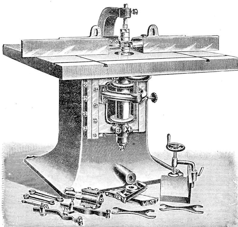
— Abrichtmaschinen mit runder Messerwelle. —
