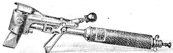
der Luftpumpe, die zur schnelleren Inbetriebsetzung des Kolbens, oder bei Arbeiten im Freien, besonders bei starker Kälte notwendig erscheint.
