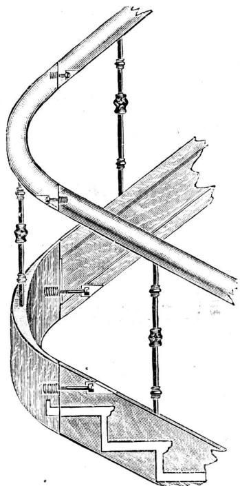
Metallschrauben-Gewinde versehenen Muffe und einem Schraubbolzen, welch letzterer die beiden zu verbindenden Holzteile durch senkrechten Druck zusammen hält. Ein Wegspalten des Holzes ist vollkommen ausgeschlossen, da die Verschraubung keinen Seitendruck ausübt, sondern wie schon gesagt, die Stoßflächen nur durch senkrechten Druck zusammen preßt. Dieses möge an folgendem kleinen Beispiel illustriert werden.
