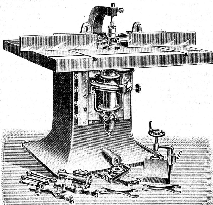
**Abrichtmaschinen mit runder Messerwelle.**
