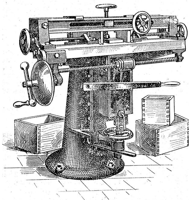
bung eines Schlittens wird eine mathematisch genaue Einteilung der Zinkenabstände erzielt und zudem ist die Maschine so konstruiert, daß diejenigen Stücke, welche die Zinkenteilung beeinflussen, leicht nachgestellt werden können, sodaß die Teilung immer exakt bleibt.
