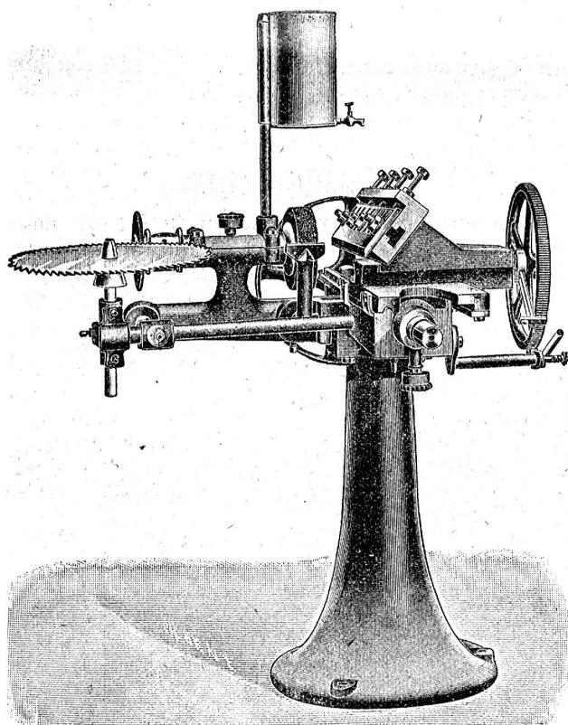
lich automatisch arbeitet, ja sogar wenn das Messer geschliffen ist, automatisch abstellt, während bei den bis jetzt bekannten Maschinen nur die Hin- und Herbewegung des Messers automatisch wirkt. Durch diese selbsttätige und gleichmäßige Schaltung wird ein feiner und haltbarer
