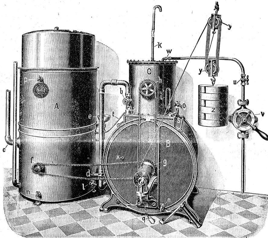
wird, steigt die Glocke entsprechend in die Höhe, schließt sobald sie die erforderliche Höhe erreicht hat, ein Ventil, welches im Innern des Gasometers sitzt und sofort muß die Gaserzeugung aufhören. Das Gebläse B kann nicht weiter arbeiten und mithin auch alle übrigen Teile nicht; erst wenn sich die Glocke senkt, wird das Ventil langsam geöffnet und zwar nur so weit, daß es das selbe Quantum Gas hindurch läßt, welches verbraucht wird.
