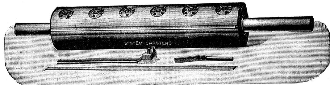
Außer der absoluten Sicherheit gegen schwere Verlebungen hat die Welle auch sonst ganz bedeutende Vorteile. Die Rundung bietet der Luft keinen Widerstand, daher leichter ruhiger Gang, somit fast kein Geräusch mehr verglichen mit dem heulenden Lärm der Bierfants-Welle. Bedeutend kleinere Ausgabe für Hobelmesser, welche stellen sich auf  $\frac{1}{4}$  des Preises der schweren Messer. Diese enorme Ersparnis macht schon allein die Anschaf-
