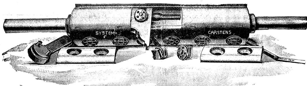
Eine wesentliche Verbesserung hat die Welle durch die geraden und schräg nachstellbaren, zum Auswechseln eingerichteten Spanbrecher erfahren. Dieser enorme Vor-
