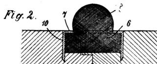
Figur 2 ist ein Vertikalschnitt durch einen im Sitzbrett befestigten Puffer.
