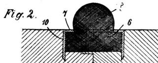
Figur 2 ist ein Vertikalschnitt durch einen im Klosetsitzbrett befestigten Puffer.
