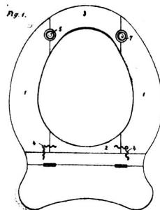
Figur 1 zeigt ein Klosetsitzbrett in Unteransicht. Der Sitz besteht hinten aus einer gesägten Anfassungsleiste, welche verhindert, daß die Feuchtigkeit durchdringt und daher ein Reißen oder Platzen des Sitzes vollständig ausgeschlossen ist.
