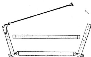
2. Dasselbe wird so zusammengeklappt, daß die Sägenarme und der Steg das Sägeblatt gänzlich einhüllen und solches somit vor etwaigen Schäden und Unfällen schützt.
