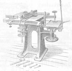
Kreissäge kombiniert mit Langlochbohrmaschine.
