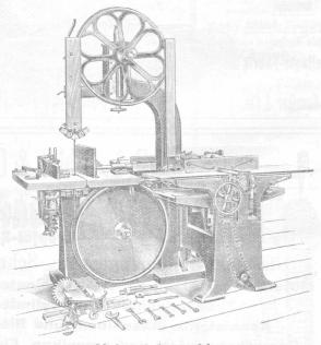
Universalmaschine bestehend mass Bandsäge (800 mm, kombinierter Hobelmaschine 450 mm breit, Kehlmaschine, Kreissäge und Langlochbohrmaschine.
