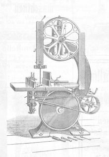
Bandsäge kombiniert mit Kehlmaschine.
