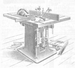
Kreissäge kombiniert mit Kehlmaschine.
