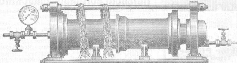
Muffe eines Rohres 300 mm Lichtweite, abgedichtet mit Bühne's Bleiwole und auf 20 Atm. gepresst.
