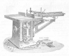
Kombinierte Kehl- und Zapfenschneidmaschine.
