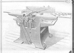
Kombinierte Abricht- und Dickehobelmaschine.
