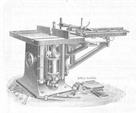
Kombinierte Kehl- und Zapfenschneidmaschine.
