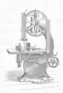
Bandsäge kombiniert mit Kehlmaschine.
