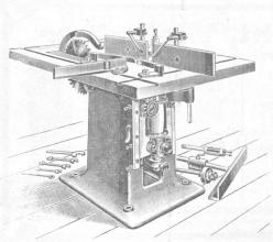
Kreissäge kombiniert mit Kehlmaschine.
