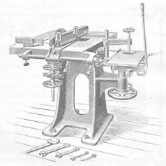
Kreissäge kombiniert mit Langlochbohrmaschine.
