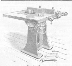
Kreissäge mit Blatt 400 mm zum Nuten u. Falzen eingerichtet.
