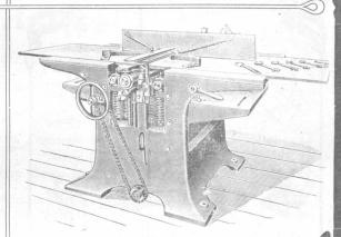
Kombinierte Abricht- und Dickehobelmaschine.
