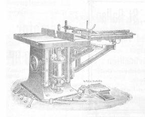
Kombinierte Kehl- und Zapfenschneidmaschine.
