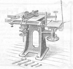
Kreissäge kombiniert mit Langlochbohrmaschine.
