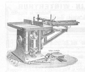
Kombinierte Kehl- und Zapfenschneidmaschine.
