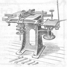
Kreissäge kombiniert mit Langlochbohrmaschine.
