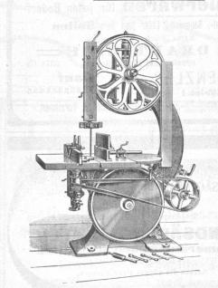
Bandsäge kombiniert mit Kehlmaschine.
