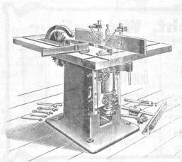
Kreissäge kombiniert mit Kehlmaschine.
