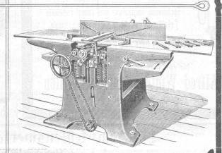
Kombinierte Abricht- und Dickehobelmaschine.
