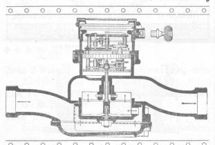
empfehlen: 2829 04 Flügelrad-Wassermesser Scheiben-Wassermesser Etagen-Wassermesser Standrohr-Wassermesser Kesselspeise-Wassermesser Wassermesser-Combinationen 475,000 Stk. im Betrieb.
