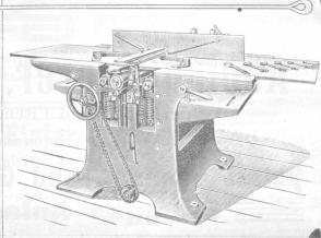
Kombinierte Abricht- und Dickehobel- maschine.
