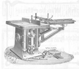
Kombinierte Kehl- und Zapfenschneidmaschine.
