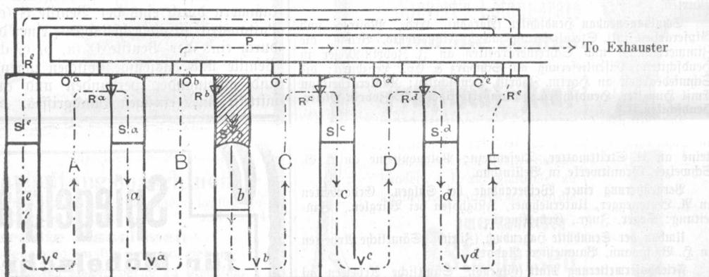
tritt bei Sein und verläßt die Maschine bei Oc. Kammer D, die jetzt die trockenste ist, erhält jetzt die Wärme von nur 1 Kammer, während Kammer C, die jetzt die nasseste ist, die Wärme von allen 5 Heizkammern erhält.
