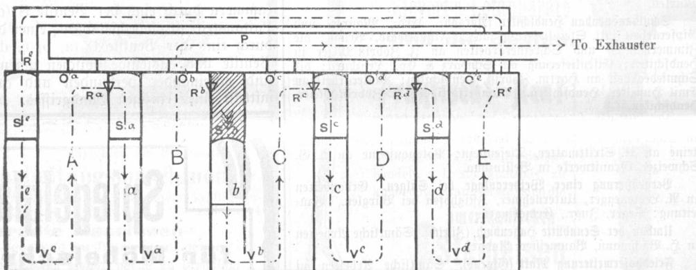
tritt bei Sc ein und verläßt die Maschine bei Oc. Kammer D, die jetzt die trockenste ist, erhält jetzt die Wärme von nur 1 Kammer, während Kammer C, die jetzt die nasseste ist, die Wärme von allen 5 Heizkammern erhält.
