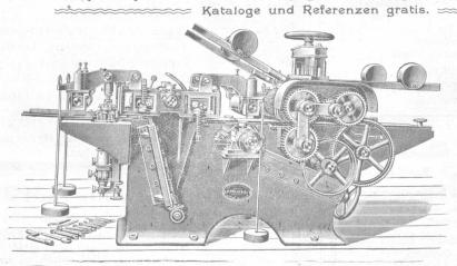
Rehlmaschinen kombiniert zum Zapfenschneiden Schleifmaschinen
