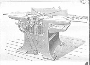
Kombinierte Abricht- und Dickehobelmaschine.
