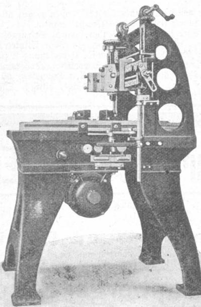
Kleine Hobelmaschine mit elektrischem Antrieb.
