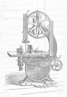
Bandsäge kombiniert mit Kehlmaschine.
