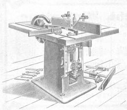
Kreissäge kombiniert mit Kehlmaschine.
