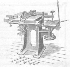
Kreissäge kombiniert mit Langlochbohrmaschine.
