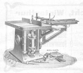
Kombinierte Kehl- und Zapfenschneidmaschine.
