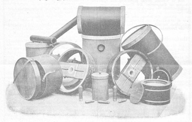
ist die Befestigung der Riemenscheibe erreicht. Keil und Nut kommen also in Wegfall und deren Wirkung wird durch öfteres Nachziehen der Schrauben erzielt.
