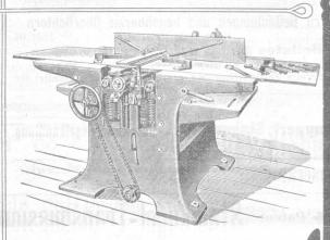
Kombinierte Abricht- und Dickehobelmaschine.
