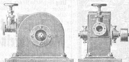
Diese tadellos, solid und sehr einfach konstruierte Turbine kann bis auf 30 m Gefall benutzt werden und zeigt eine Leistungsfähigkeit bis 70 % Nutzeffekt, von 2-10 Pferdekräften. Der billigste und beste Motor für industrielle Zwecke. Landwirte und Handwerker. — Prospekte, Kostenvoranschläge gratis.
