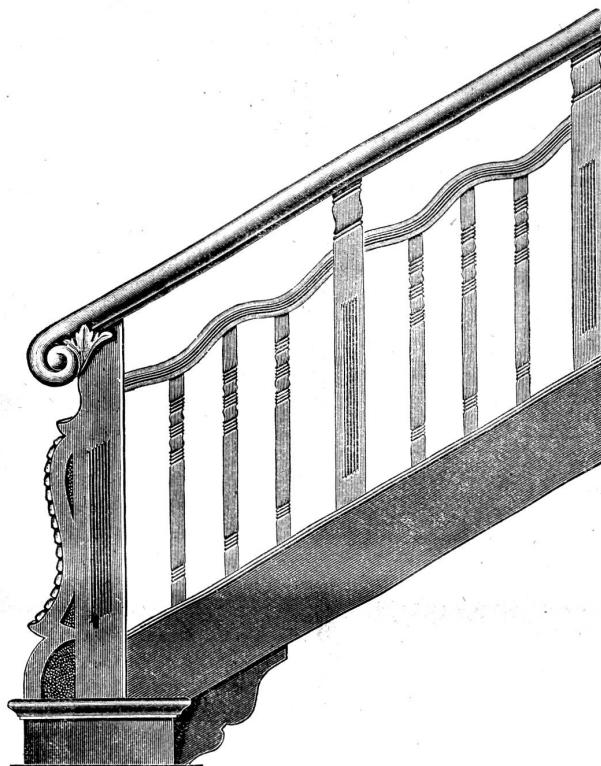
ganz eigenartige Schönheit aus. Die Bestandteile von Geländer 4 sind, dem Laufe der Treppe entsprechend, schräg profiliert. Die Staketen von Geländer 5 sind nach besonderer Methode schräg (passiv) gedreht.
