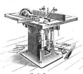
Kreissäge kombiniert mit Kehlmaschine.
