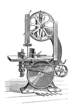
Bandsäge kombiniert mit Kehlmaschine.
