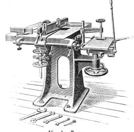
Kreissäge kombiniert mit Langlochbohrmaschine.
