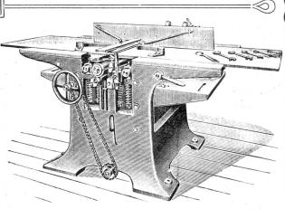
Kombinierte Abricht- und Dickehobelmaschine.
