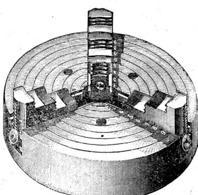
Bei diesem Futter findet durch eine Schnecke a eine gleichzeitige Verschiebung aller Backen statt; es kann
