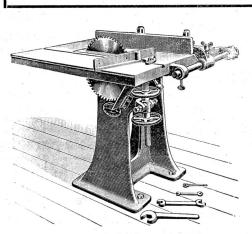
Kreissäge mit Blatt 400 mm zum Nuten u. Falzen eingerichtet.
