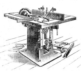
Kreissäge kombiniert mit Kehlmaschine.
