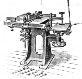
Kreissäge kombiniert mit Langlochbohrmaschine.
