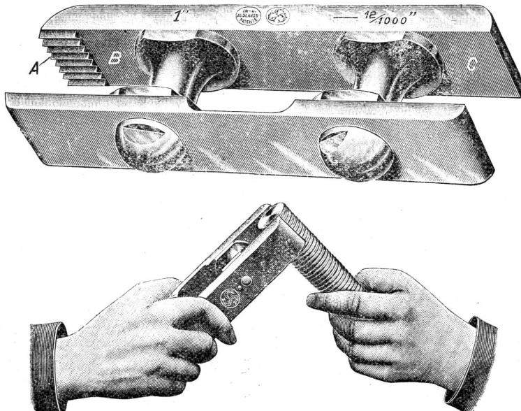
Die Handhabung ist eine höchst einfache, sie lässt sich außerst schnell und leicht erlernen und kann von jedem Arbeitsmädchen oder beliebigen Burschen ausgeführt werden. Durch Prüfen sämtlicher Schrauben, ehe sie dem Materialienlager überwiesen werden, wird die Garantie geboten, dass der Werkstatt ein gleichmäigiges, tadelloses Schraubenmaterial zugeführt wird, und alle
