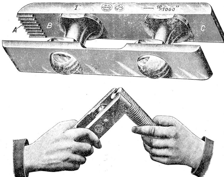
Die Handhabung ist eine höchst einfache, sie lässt sich außerst schnell und leicht erlernen und kann von jedem Arbeitsmädchen oder beliebigen Burschen ausgeführt werden. Durch Prüfen sämtlicher Schrauben, ehe sie dem Materialienlager überwiesen werden, wird die Garantie geboten, dass der Werkstatt ein gleichmässiges, tadelloses Schraubenmaterial zugeführt wird, und alle
