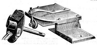
Abplattkopf mit Schutzvorrichtung
