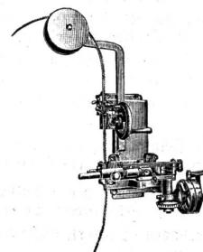
zur Hebung derartiger Werkzeugmaschinen bedarf. Im Gegenfalle hierzu weist die beistehend abgebildete neue Bandsägenfeilmashine, bei welcher alle Teile von denkbaren größter Einfachheit und kompakter, solider Konstruktion sind, hervorragende Vorteile auf, indem der Feilenstoß wesentlich langsamer erfolgt, was neben Feilenerspart ein sehr sicheres und genaues Arbeiten hervorbringt. Der Rücklauf der Feile erfolgt dagegen mit doppelter Beschleunigung.
