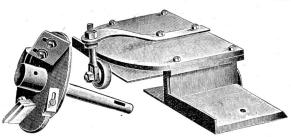
Abplattkopf mit Schutzvorrichtung
