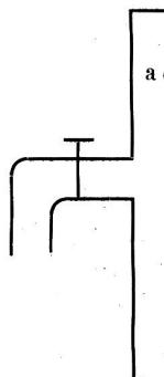
durch das Rohrende a angedeutet. Es kann sich dann die Luft in diesem erhöhten Teile anstrengen und wirkt hier gewissermaßen als Luftkissen bei dem Anpralle des Wassers. Zu grüße Ansammlung von Luft kann nicht stattfinden, da dieselbe durch die Zapfhähne mit abgeführt wird.
