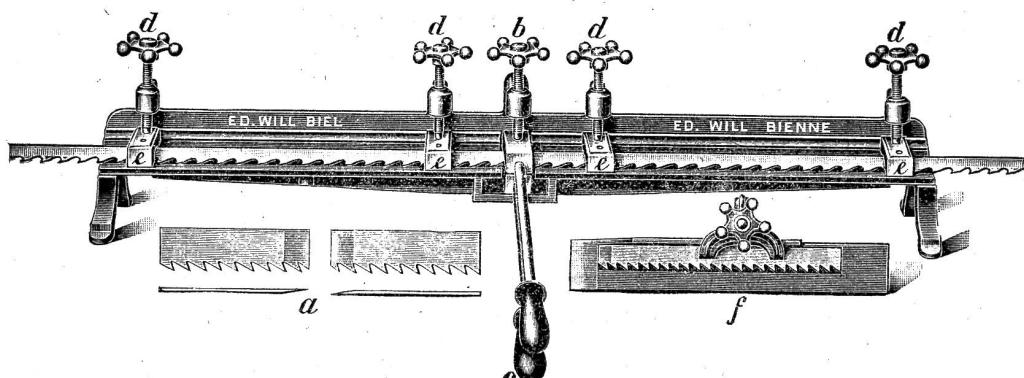
Bester Lötapparat für Bandsägen.
