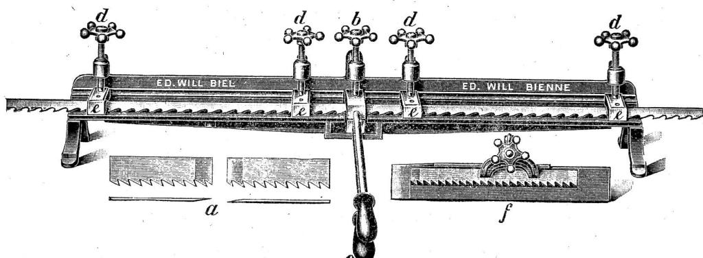
Bester Lötapparat für Bandsägen.
