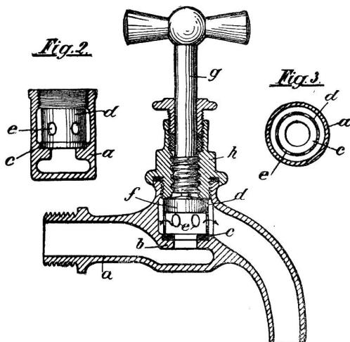
Diese Erfindung „Ideal“ genannt ist ein Wasserabzugs-Ventil, welches nicht nur in Form von neuen Hähnen geliefert wird, sondern auch in jeden beliebigen, schon im Gebrauch sich befindenden Hähnen alten
