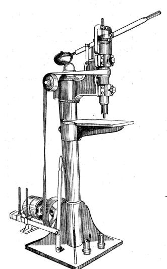
zum Herausnehmen von Aesten aus Brettern und Balken, und zum Einsetzen von Zapfen aus **Langholz.** Grosse Ersparnis an Holz und Arbeit. Viele Anerkennungen.
