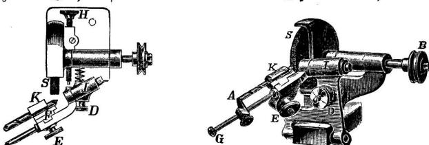
Durch Herstellung obiger Maschine wurde einem großen Bedürfnisse abgeholfen, der bis jetzt an den bestehenden Spiralbohrerschleifmaschinen existierte, da mit diesen stets nur Bohrer von 6 mm und dicker geschliffen werden konnten.
