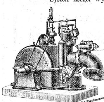
für Hochdruck, mit patentierten Löffelräder, mit oder ohne automatischen Regulator.
